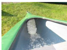
Nachdem im vergangenen Jahr das Kanu bei einer Übung unterging machten wir es jetzt mittels Ausschäumung am Bug und Heck schwimmbar-
