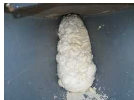
Nachdem im vergangenen Jahr das Kanu bei einer Übung unterging machten wir es jetzt mittels Ausschäumung am Bug und Heck schwimmbar-
